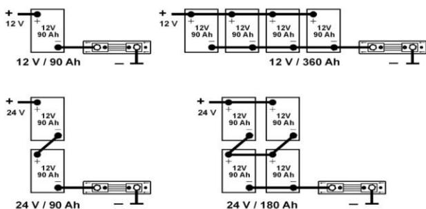
Über den Smart-Shunt müssen alle Batterieströme fließen. Er ist daher in unmittelbarer Nähe der Batterie(n) zu montieren. Nur wenn alle Ströme vom Smart-Shunt erfasst werden, kann die aktuelle Batteriekapazität richtig ermittelt werden.
